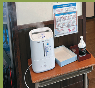
能登半島地震支援で避難所のトイレ前で消臭と除菌に効果を発揮する次亜塩素酸水超音波霧化器
