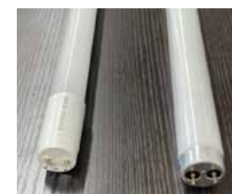
直管LEDランプ(左)と直管蛍光灯(右)
