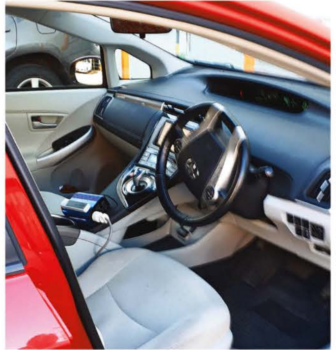
車に取り付けられた電流変換用のインバーター
